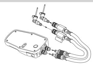
Per prima cosa – collegare gli spilli di misurazione ai flessibili di misurazione che devono essere connessi al Sensore Dp; fare attenzione alle indicazioni a colori. Chiudere la valvola di chiusura nel flessibile di misurazione.
