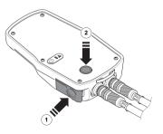
TA-SCOPE richiede automaticamente la calibratura ogniqualvolta essa è necessitata. All'occorrenza - premere il pulsante di calibratura (1) sul Sensore di Dp. Rilasciare il pulsante di calibratura (2) quando appare il messaggio di operazione completata.
