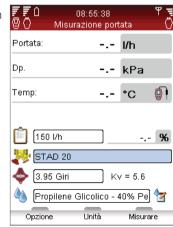
9 Confermare la scelta della valvola premendo il tasto di funzione terminare. Le tarature della valvola sono visibili nel menu Misura portata. La dimensione della valvola può essere facilmente modificata da qui; navigare con △▽ a → e scorrere con 〈 → tra le opzioni. Tipo e Gruppo rimangono immutati.
